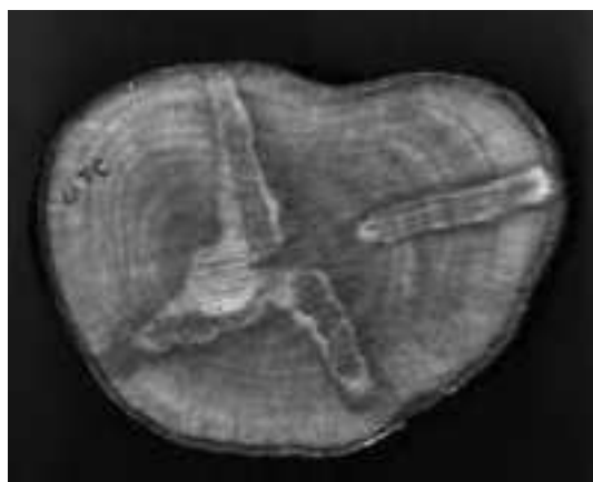
写真－1 無処理区の変色状況
