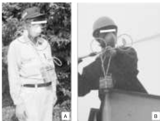
写真5 経皮暴露測定用ろ紙と吸入暴露測定用カートリッジの装着
