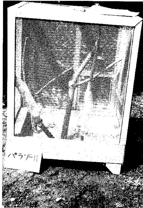
写真—1 忌避物質のスクリーニング試験 マツ枝に所定の物質を塗布または巻付けマツノ マダラカミキリ成虫を放虫して後食量を比較 (写真はパラゾールの場合)
