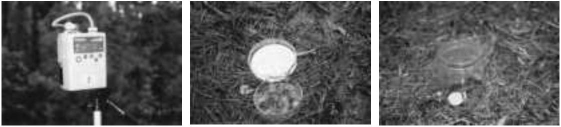
図3 新居浜での飛散調査に用いた気中濃度測定用小型ポンプとカートリッジ（左），落下量調査用ろ紙（中），バイオモニタリング用イエバエ成虫（右）
