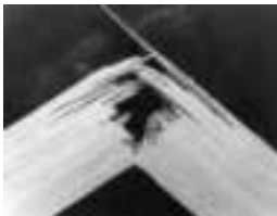
木材特有の破断面
