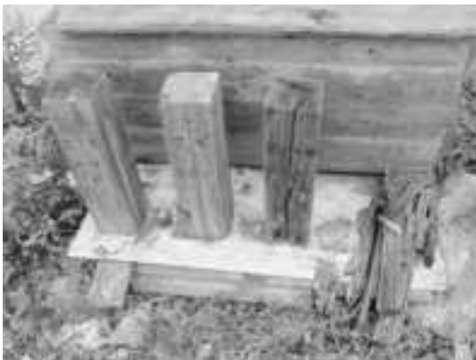
4年半野ざらしの柱角材、左からスギ、ヒノキ、ベイツガ、オウシュウトウヒ集成材（榎戸木材店）
