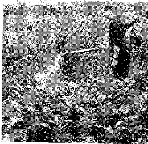
写真-3 先行地掃えを目的とした雑木処理に用いられる背負式動力噴霧器
